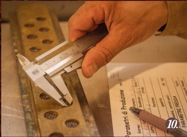
Verifica scrupolosa delle trafilie Scrupulous check of the bronze dies
